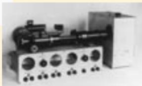
写真電送装置(送信機(台))
