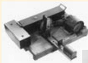
写真電送装置(送信機)
