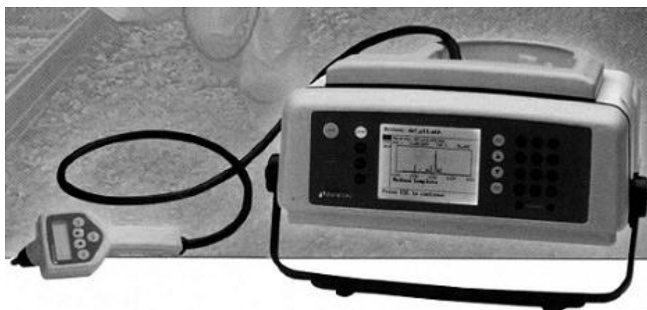
【図】 ゲッターポンプを用いたポータブル GC-MS
