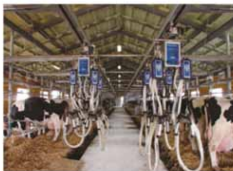
搾乳ユニット自動搬送システム “キャリロボ” 特許第 3619470 号 第 3760145 号 第 3729492 号
