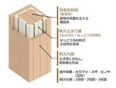
中高層木造建築を実現する耐火集成材「燃エンウッド®」 Fire-resistant Wooden Laminated Material "Moen Wood" for Realizing Mid- to High-rise Wooden Buildings
