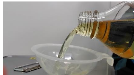
イオン交換樹脂法により製造したバイオ燃料 Biofuel Produced by Ion Exchange Resin Method
