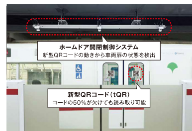
【東京都交通局】 電車のドアにQRコードを表示し、ホームドアと連携させて開閉制御を行うシステムもお客さまの声から開発された。
