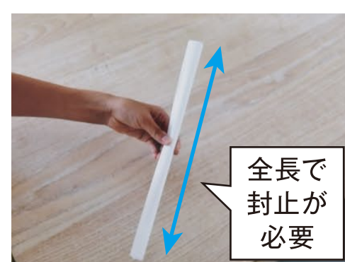
【図1】全長を封止しないと水や空気が漏れる。
