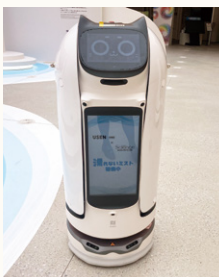
業務用ロボットの導入・運営ノウハウを持つUSENとサイエンスの技術が共同開発した、濡れないミストを噴霧するロボット
