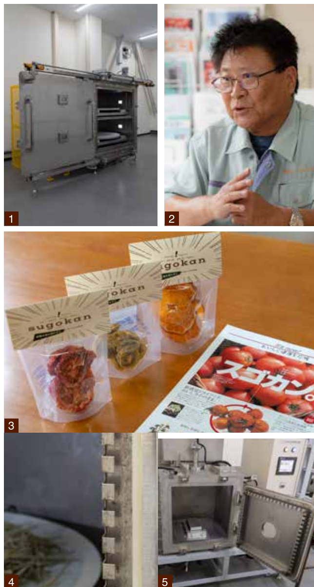
【1】トレイが二段や三段のタイプなど、顧客のニーズに合わせた機械設計を行う 【2】岡村邦康代表取締役 【3】マイクロ波減圧乾燥機を利用したドライ食品。低温かつ高速で水分を蒸発させるので素材本来の色や香り、栄養価を保てる 【4】チョコの凸凹が噛み合う形でマイクロ波の漏洩を防ぐ扉構造(マイクロ波減圧乾燥機) 【5】マイクロ波減圧乾燥機のラボ機
