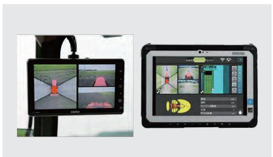
各所に取り付けられた車載カメラとセンサーによって、農機の周辺情報を把握しながら無人走行する。携帯端末で車外から無人車両の周辺監視も可能。
