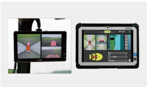
各所に取り付けられた車載カメラとセンサーによって、農機の周辺情報を把握しながら無人走行する。携帯端末で車外から無人車両の周辺監視も可能。
