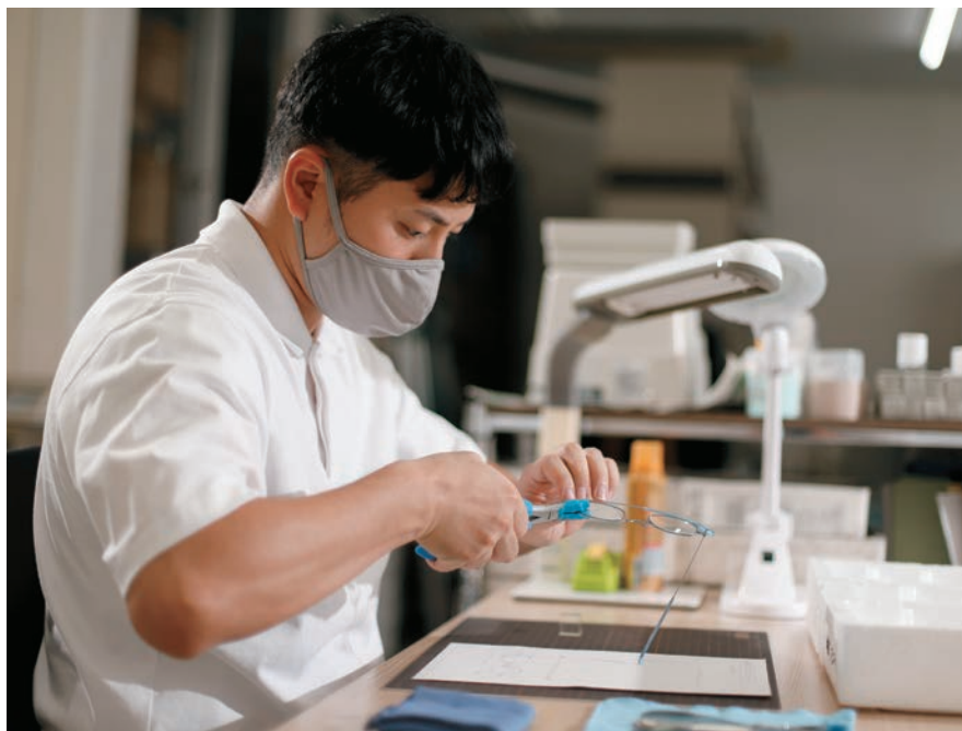
出来上がったペーパーグラスの最後の仕上げの工程「調子取り」。バランスを取りながらすっきりと平たんに仕上げるのは難しく、手作業での高い技術が要求される。
