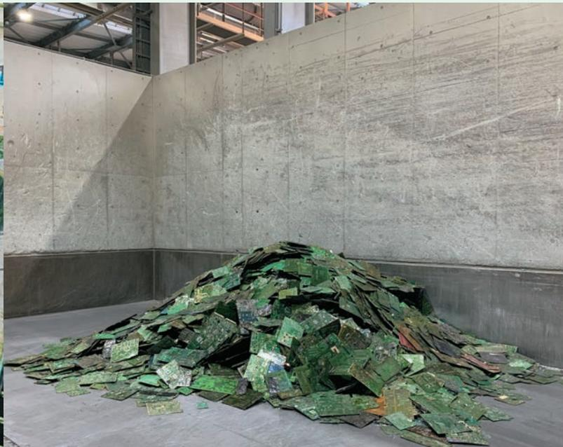
同社における電子機器類の廃基盤(E-Scrap)のリサイクル処理能力は年間約16万トンにおよび、実に、全世界の発生量の約20パーセントを占める。国内2箇所の製錬所で高純度の地金にリサイクルされる。
