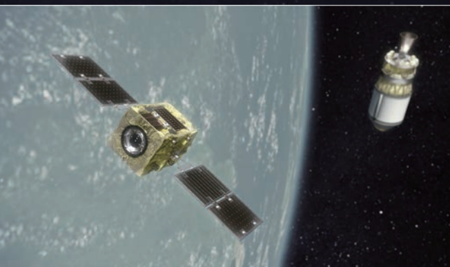
(上) ELSA-dミッションでは、磁石を用いた捕獲機構や、自律的な接近マヌーバおよび姿勢制御を含め、デブリ除去のためのコア技術の実証に成功している。 (左) ADRAS-Jは、実際のデブリへの安全な接近を行い、デブリの状況を明確に調査する世界初のミッション。
