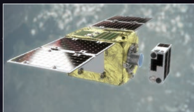
(上) ELSA-dミッションでは、磁石を用いた捕獲機構や、自律的な接近マヌーバおよび姿勢制御を含め、デブリ除去のためのコア技術の実証に成功している。 (左) ADRAS-Jは、実際のデブリへの安全な接近を行い、デブリの状況を明確に調査する世界初のミッション。
