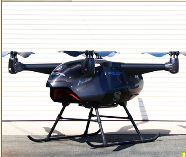
A 2024年4月に福島県浪江町で開催の自社イベント「結」で、避難支援誘導システム「The Guardian」を浪江町に実装し、スマホアプリの映像を会場のスクリーンに投影 B 「The Guardian」にリアルタイムで情報映像を送る超無人機「AZ-1000」は1000ccのガソリンエンジンを搭載する
