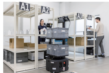
「rapyuta.io」を活用した物流倉庫内で活躍するピッキングアシストロボット
