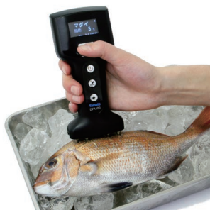
魚の脂肪を簡便・迅速・高精度に測定できる魚用品質状態判別装置「フィッシュアナライザ」
