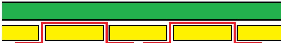
15 ウ したがって、本件発明の構成要件Cにおける「複数の貫通穴を通して前記金属製外殻部材の内面と外面を交互に通り、その形状を維持されたF R P製糸部材」を被告製品の複数の帯片8に置き換えたとしても、同一の作用効果が得られる。
