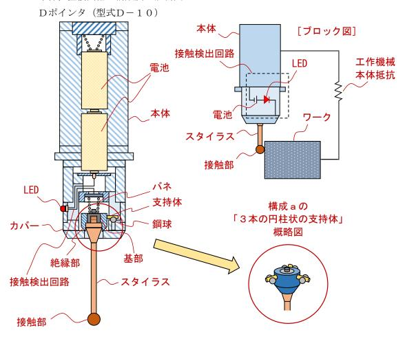
本件位置検出器は、接触体の接触部が、位置測定の対象である被加工物等に接触したとき に閉回路が形成されて電流が流れ、その電流を検出して位置を測定する「通電方式」を採用 している。
