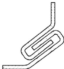
断面図などの切断面には、平行斜線を引き、その断面中異なる部分を表す切断面には、方向を異にする平行斜線又は間隔の異なる平行斜線を引きます。
