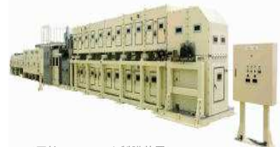
＜同社のPIフィルム製膜装置＞
