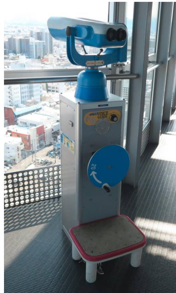
＜ゼンマイ式手回し発電装置を応用した音声ガイド装置＞
