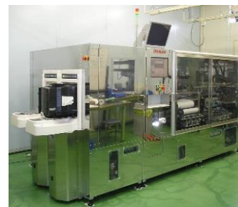
＜マイクロボールマウンタ「BM-1300」の製品写真(左)とマイクロボール実装技術を活用したウェハー用ボールマウンタ＞
