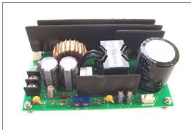
<絶縁型DC/DCコンバータ>
