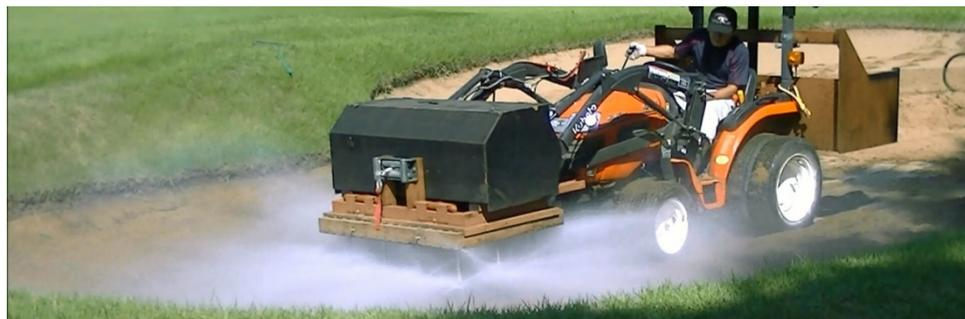
＜東北グリーン興産開発の特許工法 逆洗浄ノズルによるバンカー砂の逆洗浄作業＞
