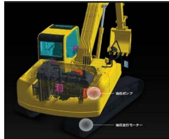
＜バイメタル製シリンダーブロックを使用した建設機械＞
