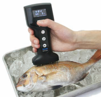
魚の脂肪を簡便・迅速・高精度に測定できる 魚用品質状態判別装置「フィッシュアナライザ」
