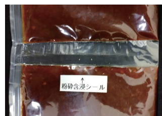
TypeⅢによる粉碎含浸®シールの状態 革新的な粉碎含浸®法による 流動固形物を含んだ液中連続充填包装
