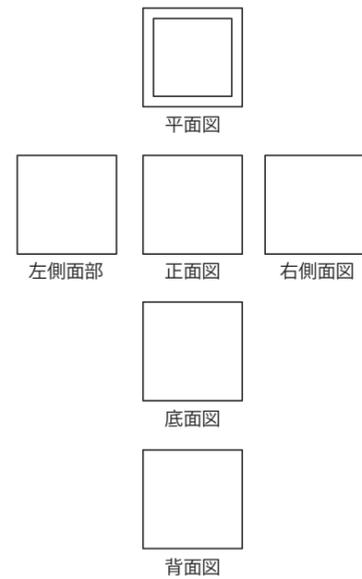
六面図だけだと、平面図に現れた内側の正方形が、蓋を表しているのか、それとも内側に凹んだ収容部を表しているのか、またその深さはどれくらいなのか不明確です。
