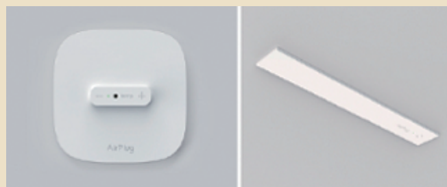
※AirPlug®は、マイクロ波を用いて、右の送電機から左のセンサー (AirPlug® Sense) にワイヤレスに給電可能とする給電ソリューション
