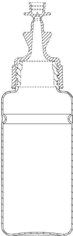
【上端部を切り離し栓として使用した状態の正面図】
