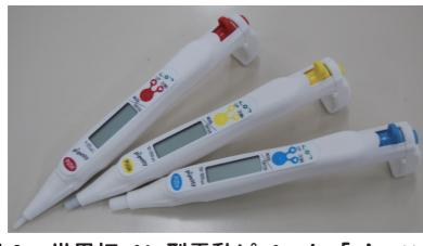
図4 世界初ペン型電動ピペット「pipetty」
