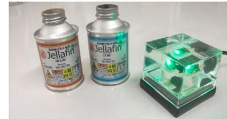
耐圧防水樹脂「ジェラフィン」(左)及び「ジェラフィン」が充填された発光素子のサンプル(右)
