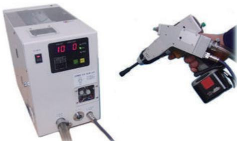
▶空気圧送式自動ネジ供給システム
