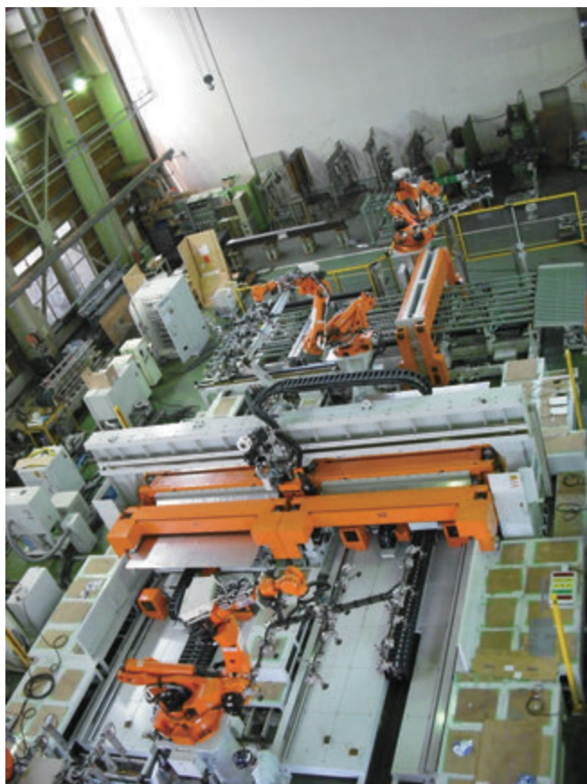
▶ 高性能材料突合せ機構を採用したレーザ溶接システム
