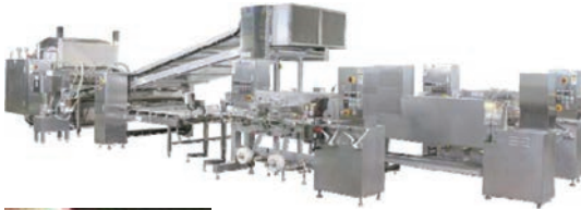
▲カニカマ製造装置 「カニカマライン」
