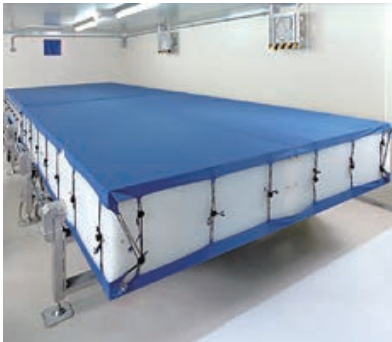
▲VEX方式 完全無通風製麴装置 (吟醸酒製造)
