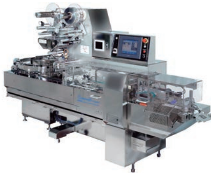
▲横形ピロー包装機FW3401HSαⅦ 超高速（1,800個/分包装）
