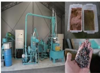
▲特許製品の剥線機（左）と仕上がり銅（右）
