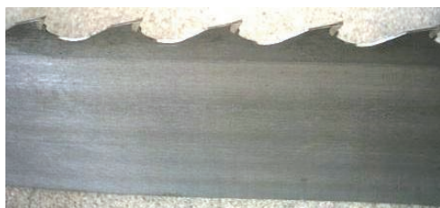
▲ タングステンチップ刃 (鋸厚管理不要、海水によるサビにも対応)
