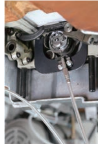
▲下糸残量検出装置 縫い目が切れることなく縫い直しを防止
