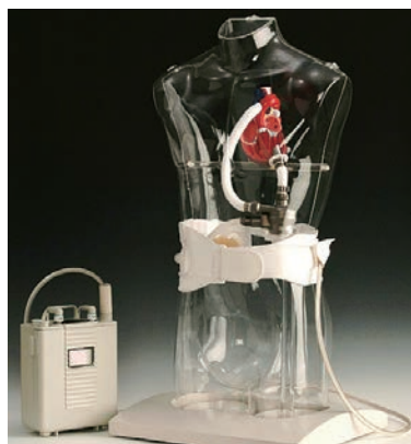
▲エヴァハート（体内で補助心臓として機能する血液ポンプと、体外からこれを制御するコントローラで構成。）
