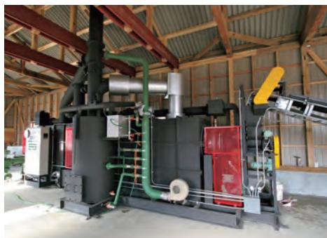
▲自社製炭化装置 12型還元滅菌炭化加工機(SUMIX)
