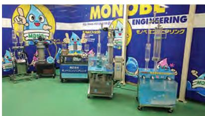
▲各種デモ装置（懸濁物質と溶存金属のろ過捕集）
