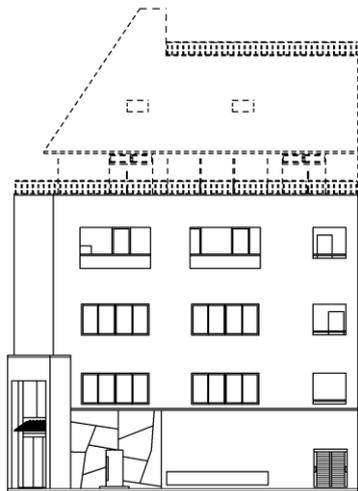
【アルミキャストパネル部分を外した状態を示す左側面図】
