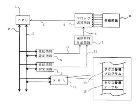
性能情報設定回路Performance information setting circuitクロック選択回路Clock selection circuit選択情報生成回路Selection information generation circuit発振回路Oscillation circuitタスク管理プログラムTask management programタスク管理テーブルTask management tableメモリMemory
