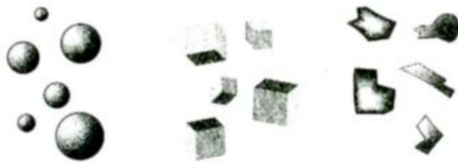
図 1. 3 粒子の大きさ (球、立方体、石灰石) (sphere, cube and limestone)
